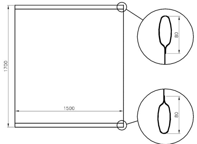
Die Zargen werden in den Bannerlaufgänge geschoben und das Banner wird durch die Montierung zwischen den Stützen gespannt.
