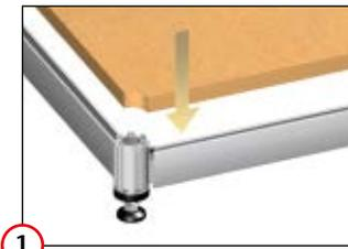
1 Verbinde Stützen und Zargen – ohne Werkzeug. Bodenplatten auslegen.
