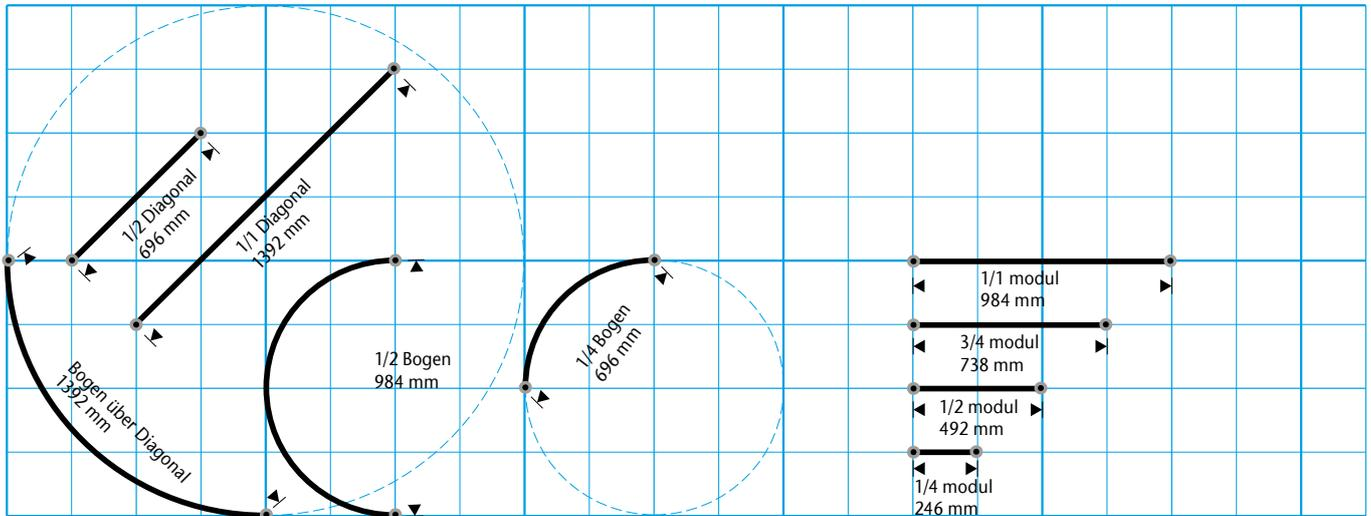
Die Module sind mit einem Modulmaß von 984 mm von Stützenmitte zu Stützenmitte ausgelegt, wodurch die Module immer in Messehallen mit Metereinteilungen Platz finden. Die Zargenlängen sind dem Modulmaß angepaßt. Die Wandpaneele werden passend im Modulmaß abz. 32 mm geschnitten. Siehe mehr bez. Plattengrößen auf Seite 22. Das System kann auch in anderen Maßen laut Ihrer Aufgabe geliefert werden.
