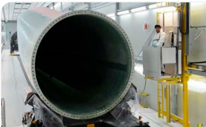
100 m lange Lackier- und Trockenkabine mit Zonenlüftung gemäß EN 16985. Der Energieverbrauch wird zu 1/6 reduziert, ohne dabei die Sicherheit zu beeinträchtigen.
