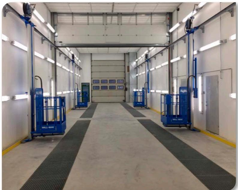
Exemple : Cabine de pulvérisation double avec une porte intermédiaire à enroulement. Les plates-formes des opérateurs peuvent passer par la porte ouverte.
