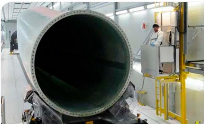
cabine de pulvérisation/séchage de 100 m de long avec ventilation par zone selon la norme EN 16985. La consommation d'énergie est réduite à 1/6e sans compromettre la sécurité.
