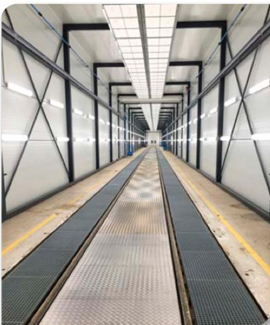
Exemple : Cabine de pulvérisation de 120 m de long avec plus de portes roulantes intermédiaires. Les portes ne sont pas visibles lorsqu'elles sont ouvertes.
