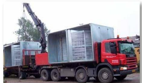
Intercambiador de calor cruzado doble para unidad de 80.000 m<sup>3</sup>/h
