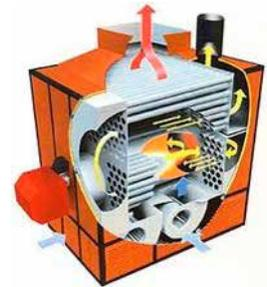
Diagrama de quemador e intercambiador de calor
