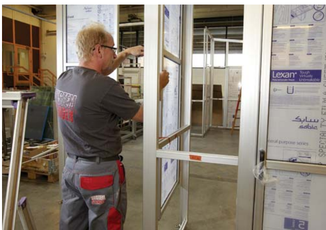
System Standex bietet auch vorgefertigte Systeme, als Bausatz geliefert für die Fertigstellung vor Ort an.
