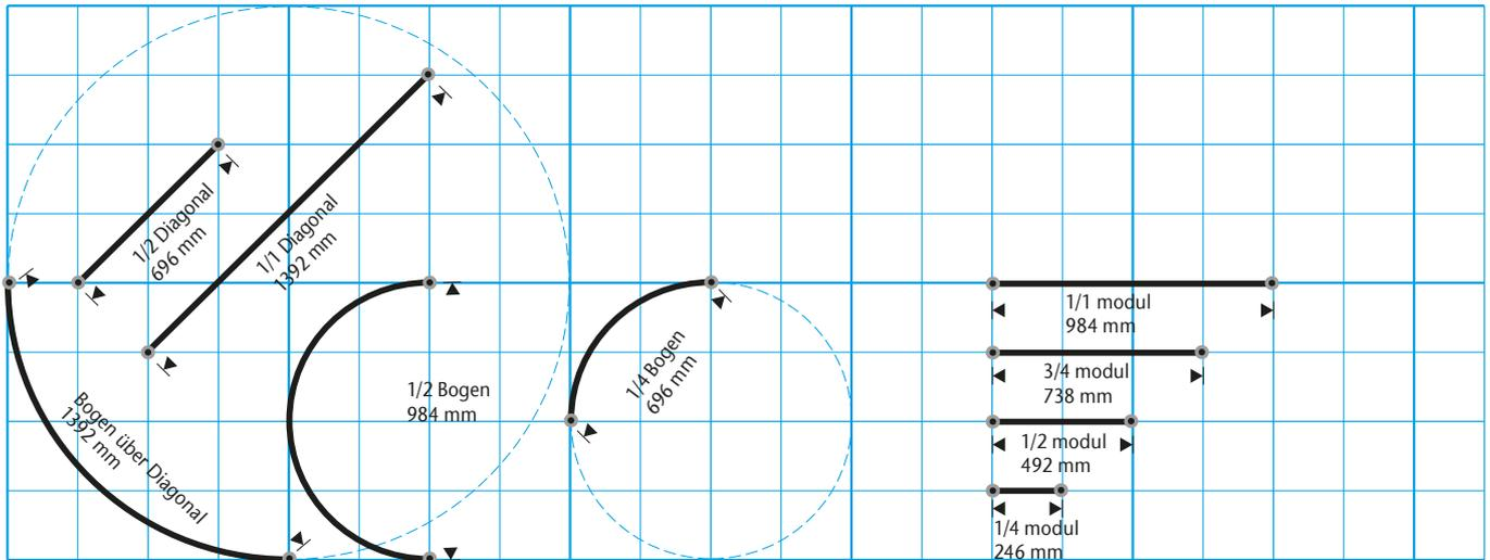
Die Module sind mit einem Modulmaß von 984 mm von Stützenmitte zu Stützenmitte ausgelegt, wodurch die Module immer in Messehallen mit Metereinteilungen Platz finden. Die Zargenlängen sind dem Modulmaß angepaßt. Die Wandpaneele werden passend im Modulmaß ab 32 mm geschnitten. Siehe mehr bez. Plattengrößen auf Seite 22. Das System kann auch in anderen Maßen laut Ihrer Aufgabe geliefert werden.
