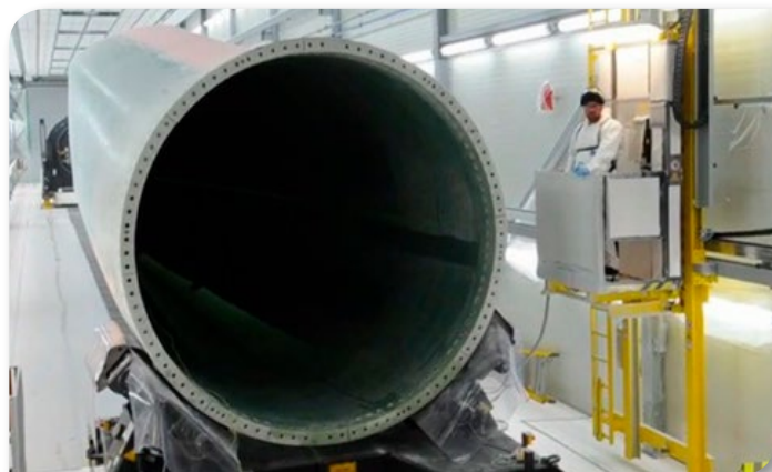
100 m lang sprøjtekabine med zone-opdelt ventilation. Reducerer energiforbruget til ca. 1/6 uden at gå på kompromis med sikkerheden.
