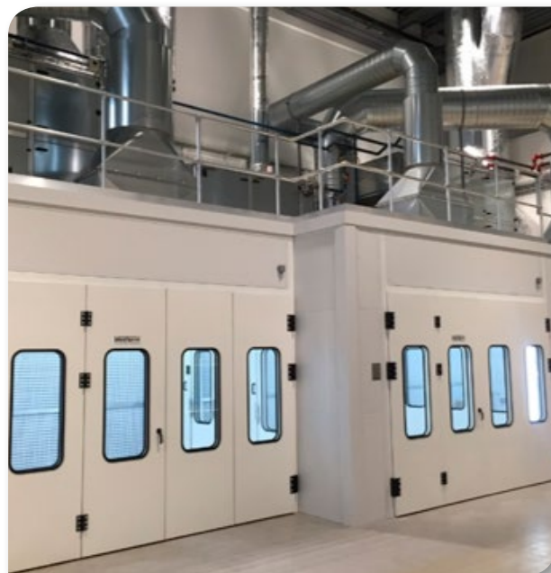
Ovenfor: Kongsberg Defence & Aerospace, Norge. 3 sprøjtekabiner med horisontal ventilation.
