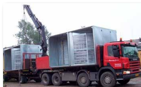
Dubbel korsvärmewäxlare för aggregat på 80 000 m 3 /h
