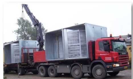
Doppelter Kreuzwärmetauscher für eine Einheit von 80.000 m 3 /h
